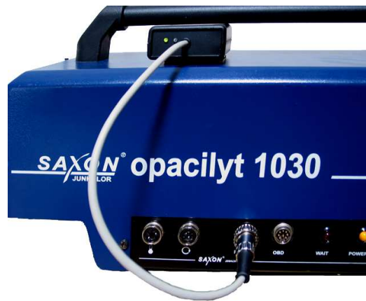
Abb.8: Anschluss des BT Adapter an Opacilyt 1030
